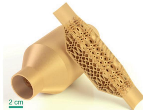
→ **Abbildung 2:** Additiv gefertigter Rohrschalldämpfer (links: Vollversion, rechts: Viertelschnitt)
