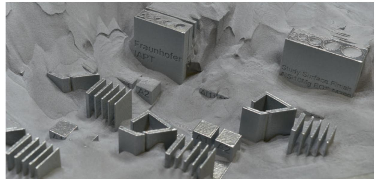
→ **Abbildung 1:** Probekörper für die Surface Benchmark Study
