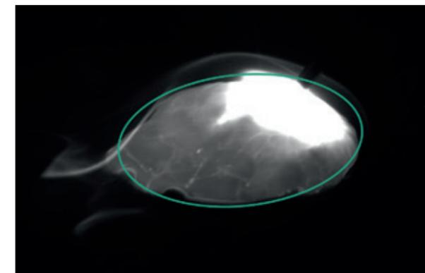
→ **Abbildung 1:** SenseLight-basierte In-situ-Schmelzbadüberwachung mit detektierter Ellipsenkontur
