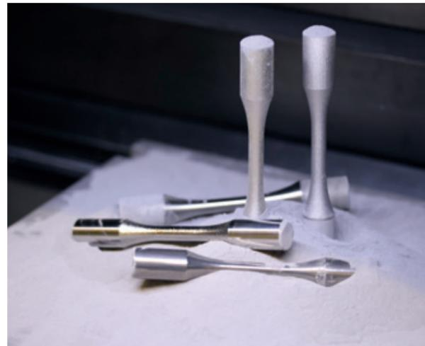
→ **Abbildung 3:** Additiv gefertigte und nachbearbeitete Proben für die Additive Fatigue Study
