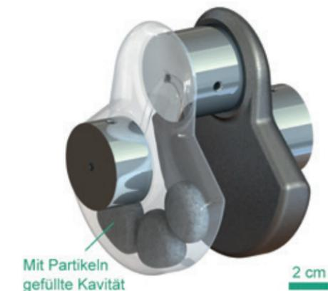
→ **Abbildung 3:** Additiv gefertigte Kurbelwelle (Ausschnitt) mit integrierten Partikeldämpfern (die vordere Schwungmasse ist transparent dargestellt)
