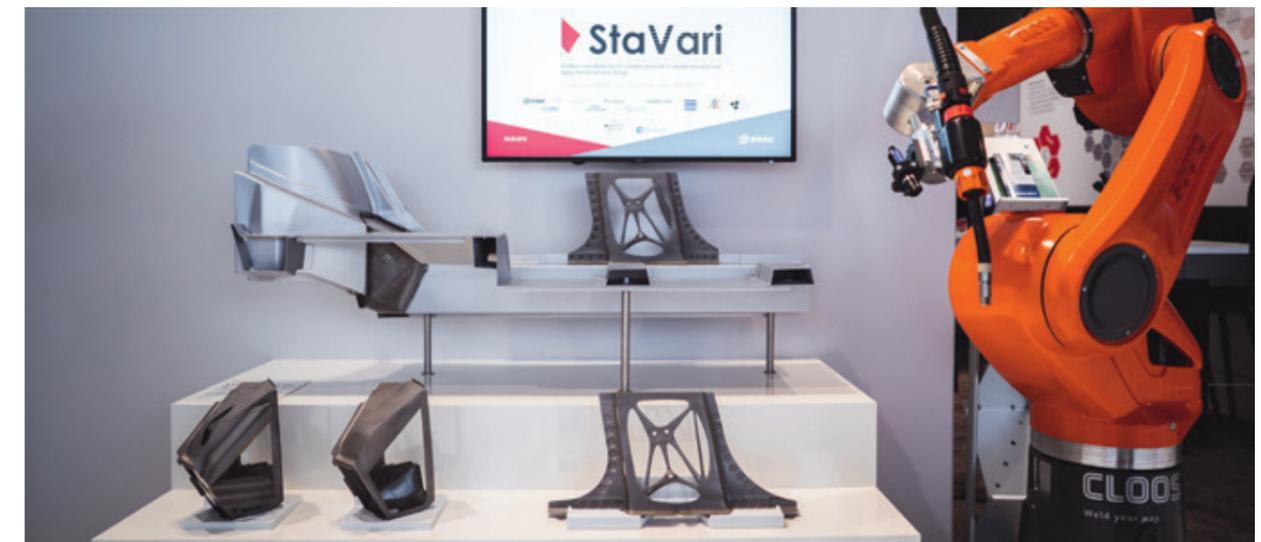
→ **Abbildung 2:** Für ein Elektrofahrzeug konzipierte Demonstratorbaugruppe der Fa. EDAG, die das Radhaus, additiv gefertigte C- und B-Säulenknoten, Schweller sowie die angrenzende Bodengruppe einer Karosserieseitenstruktur umfasst
