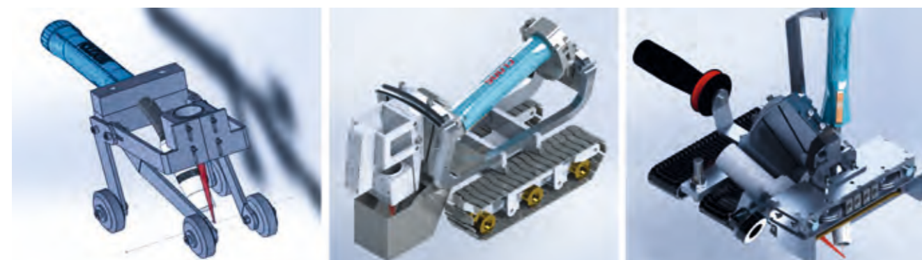
→ Abbildung 4–6: Evolutionsstufen des vom Fraunhofer IAPT entwickelten ShipLight-Handschweißgeräts für verschiedene Fügeanordnungen (Quelle: Fraunhofer IAPT)
