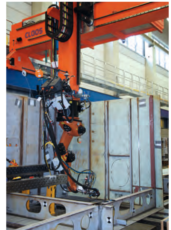
→ Abbildungen 2 und 3: 2) Siehe Bild oben – ShipLight-Bearbeitungskopf von Cloos mit integrierter Fugenfolgesensorik; 3) Einsatz des vollautomatischen Bearbeitungssystems im Fraunhofer IAPT (Quelle: Fraunhofer IAPT)
